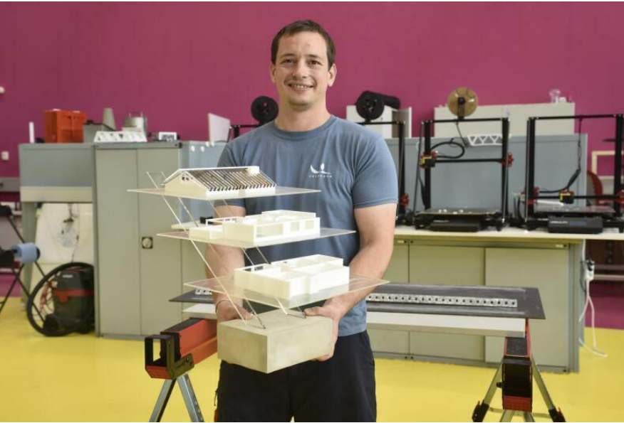
Florian Kopp präsentiert das mit Hilfe digitalisierter Pläne stockwerkweise hergestellte CAD-Modell eines Hauses.
